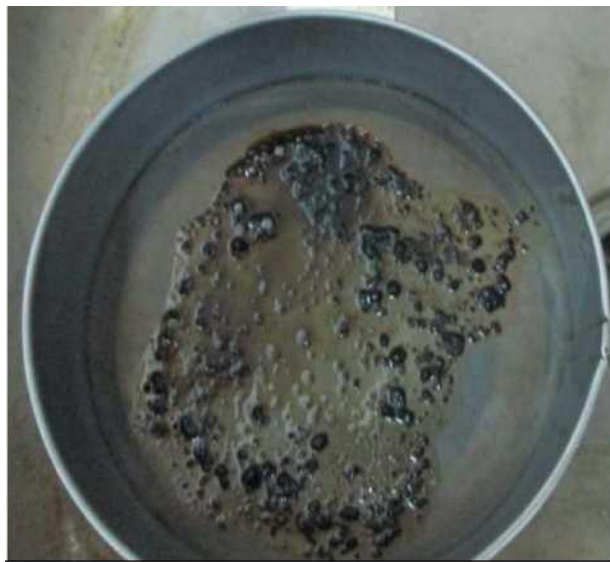
Рисунок 1 – Фильтрация нефти С-Даниловского месторождения после прогрева с КС ГКС(12НС1 + 2% HF). АСПО в наличии
