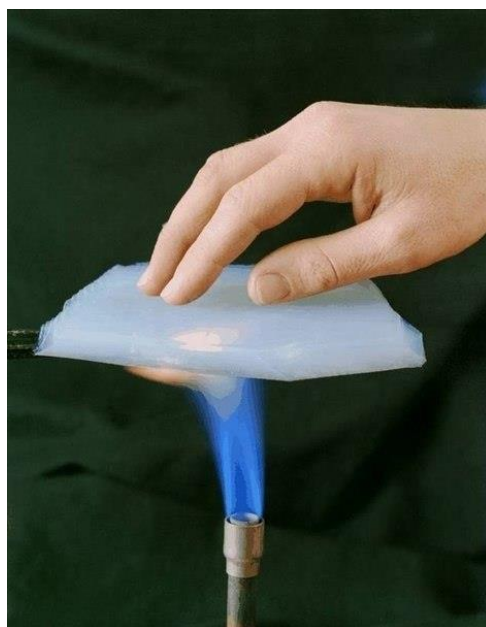
Рисунок 5 – Испытание теплоизоляционных и деформационных свойств аэрогеля
