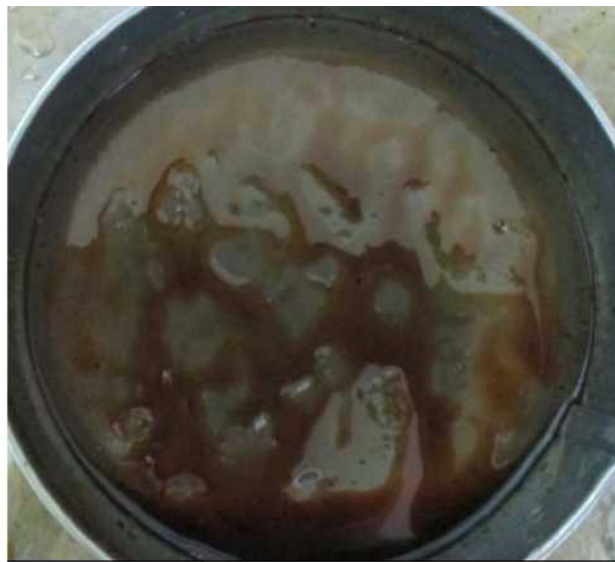
Рисунок 2 – Фильтрация нефти С-Даниловского месторождения после прогрева с КС ГКС+спирт. АСПО отсутствуют
